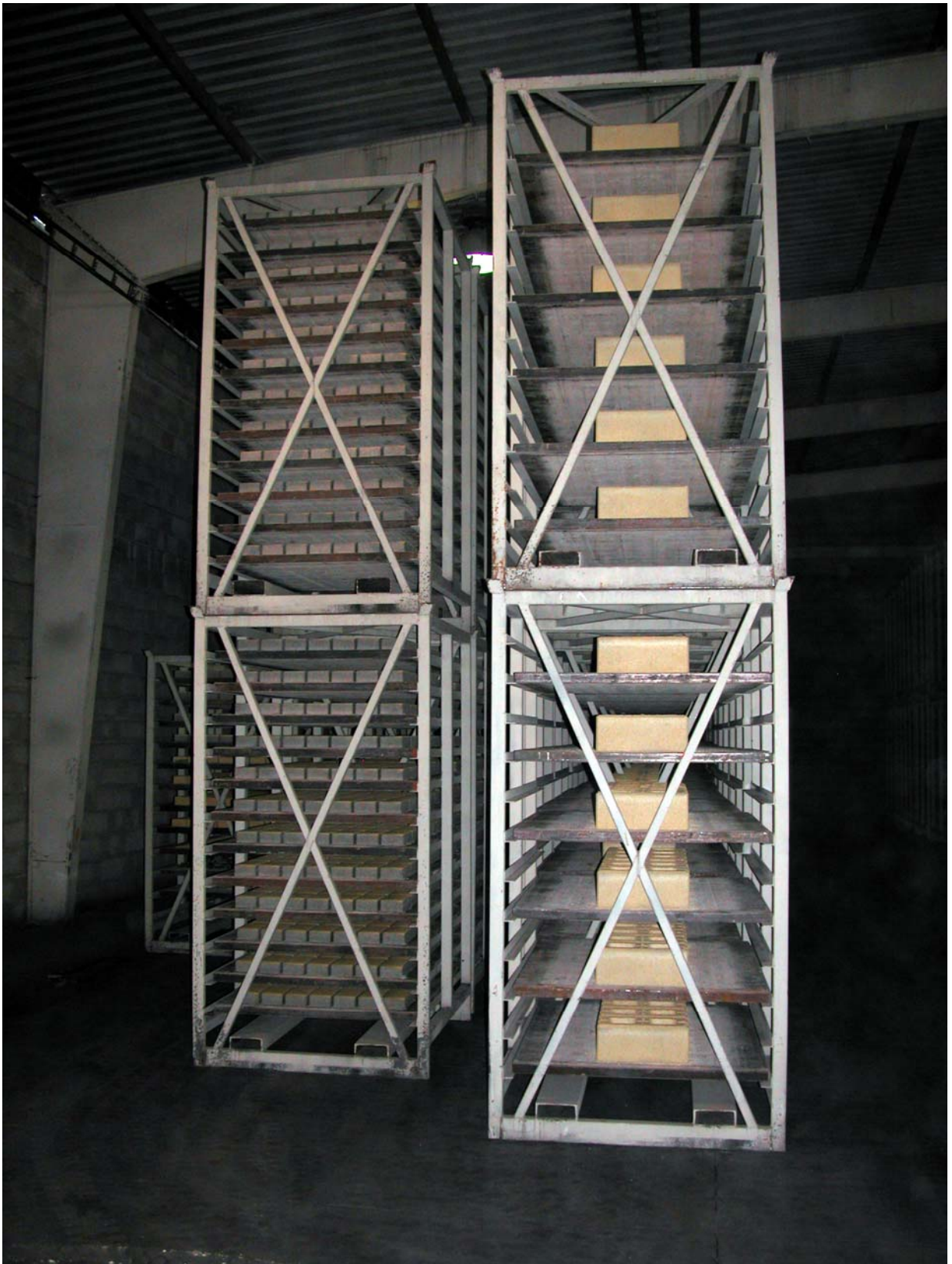
Вид на склад набора первичной прочности. Тротуарная плитка толщиной до 100 мм хранится в кассетах с суммарной этажностью 24 этажа, более высокие изделия высотой до 350 мм хранятся максимально на 12 этажах.
