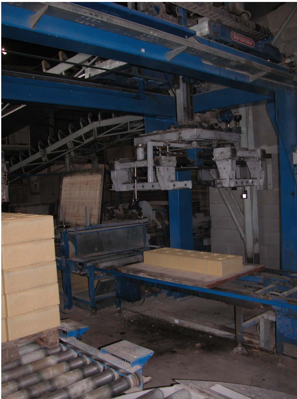
Пакетировщик портального типа для послойного перемещения и штабелирования изделий.
