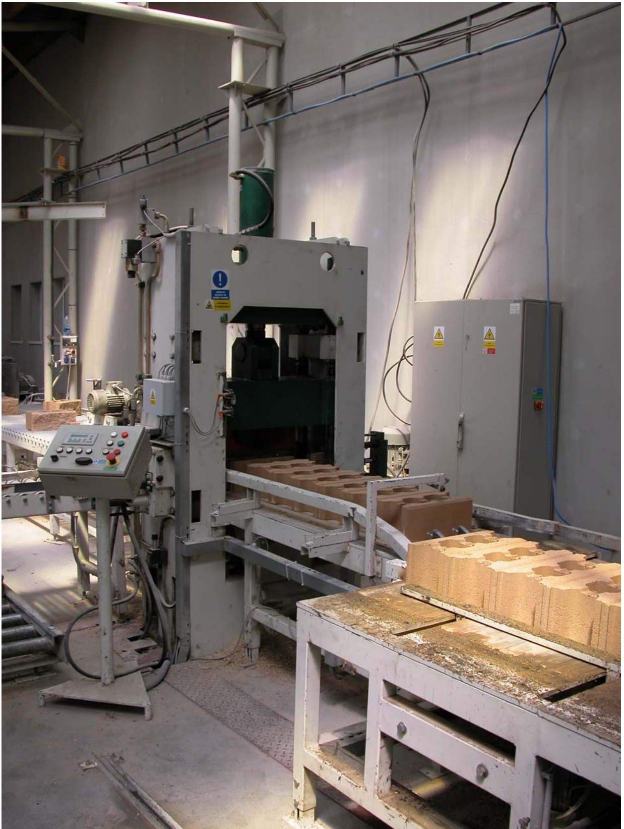
Подача специально отформованных изделий для «колки» машиной под названием «сплиттер».
