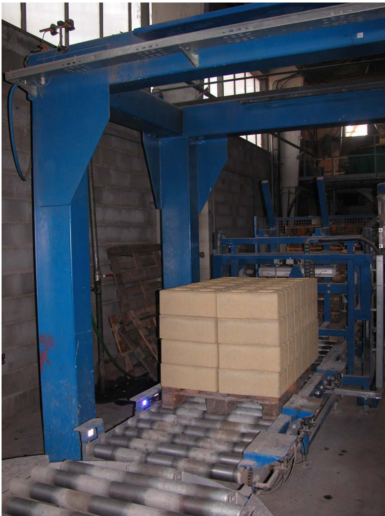
Зона пакетировки. Рольганг с поворотным столом на переднем плане для перемещения штабелей готовых изделий за пределы цеха.
