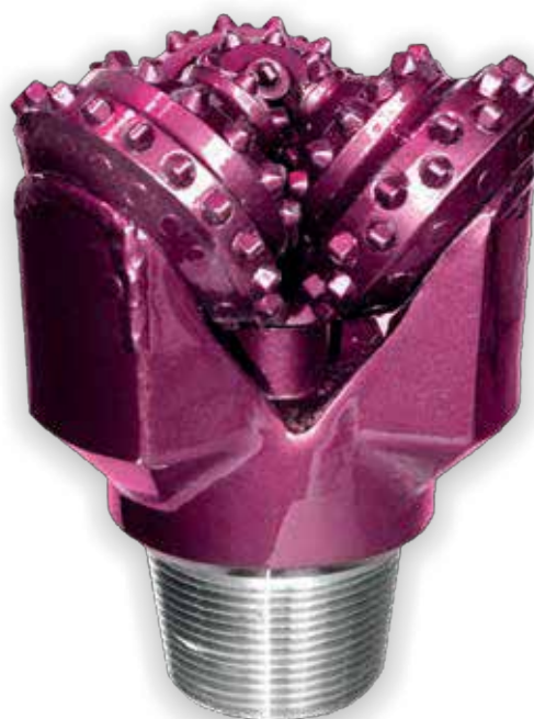
Трехшарошечное долото с твердосплавным вооружением с продувкой
