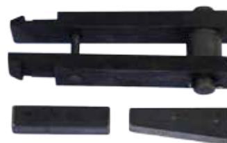
Приспособление для выемки седел
